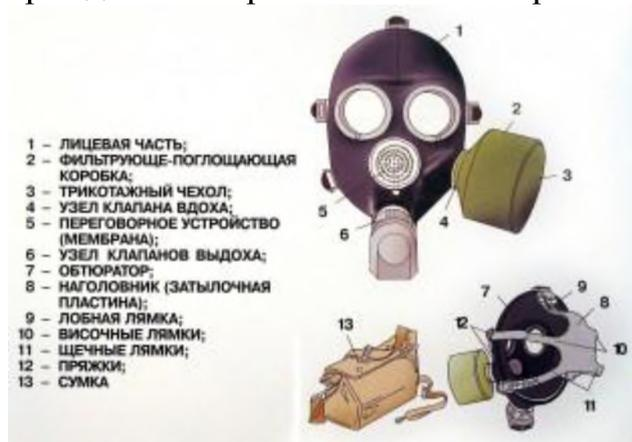
Лицевая часть гражданского противогаза ГП-7 состоит из корпуса маски объемного типа, оснащенного обтюратором, отформованным за одно целое с корпусом маски, очкового узла с плоскими стеклами круглой формы, переговорного устройства, узлов клапана вдоха и клапана выдоха, оголовья с пятиточечным креплением к корпусу маски. Лицевая часть имеет пятиточечное крепление лямок оголовья. Прочность
